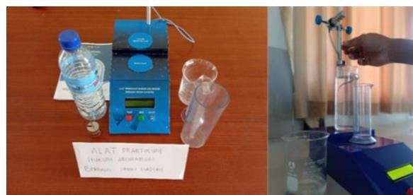
**Gambar 3.** Wujud Fisik Alat Praktikum Hukum Archimedes Berbasis Sensor Load Cell
